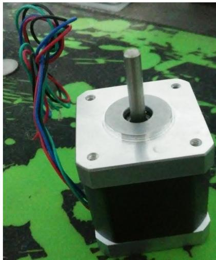
Figura 4.4: Motor de passo 17HS4401/42BYGH. O motor de passo garante precisão e torque a um baixo custo, sem a necessidade acessórios externos para seu funcionamento. A sua facilidade de operação, configuração e uso é também um importante ponto a ser considerado para a escolha desse tipo de motor.
