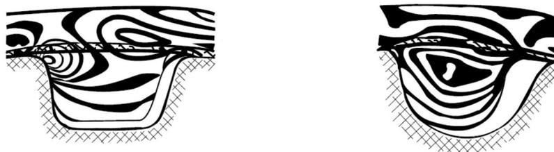
Figura 4.17: Distribuição de tensão nas correias. Através dessa figura, fica evidenciado a forma como a tensão se distribui em relação ao tipo de dente da correia. É interessante observar que o dente redondo apresenta uma distribuição mais uniforme quando submetida a um esforço pela polia acoplada a ela. Fonte: <https://www.sdp-si.com/>.
