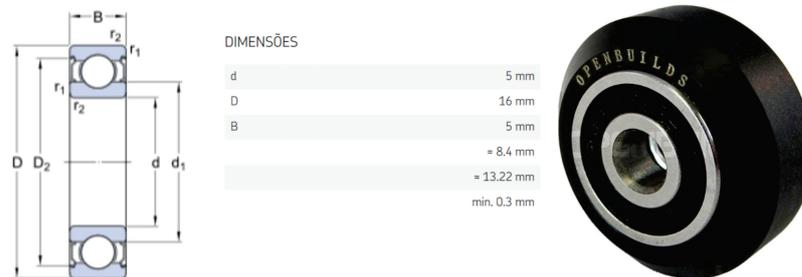
Figura A.6: Roldana 625zz e polia em Delrin. Esse conjunto de componentes são responsáveis pelo deslocamento através do encaixe da polia na estrutura do perfil de alumínio, permitindo o movimento linear de componentes acoplados a roldana. Fontes: <https://www.skf.com> e <https://openbuildspartstore.com>.
